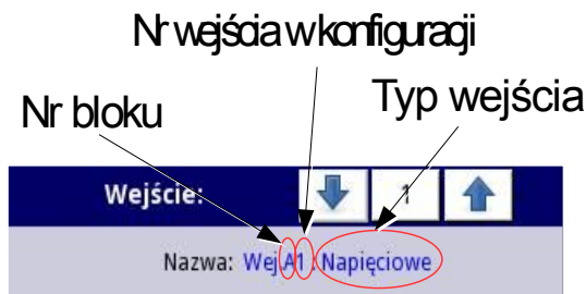
Rys. 7.88. Sposób zapisu Nazwy wejścia wbudowanego
