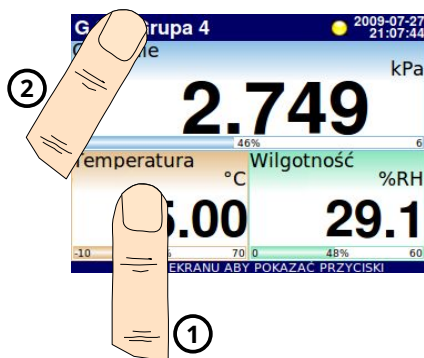
Rys. 6.7. Sposób bezpośredniego wejścia do konfiguracji Kanału logicznego (1) i konfiguracji Grupy (2)
