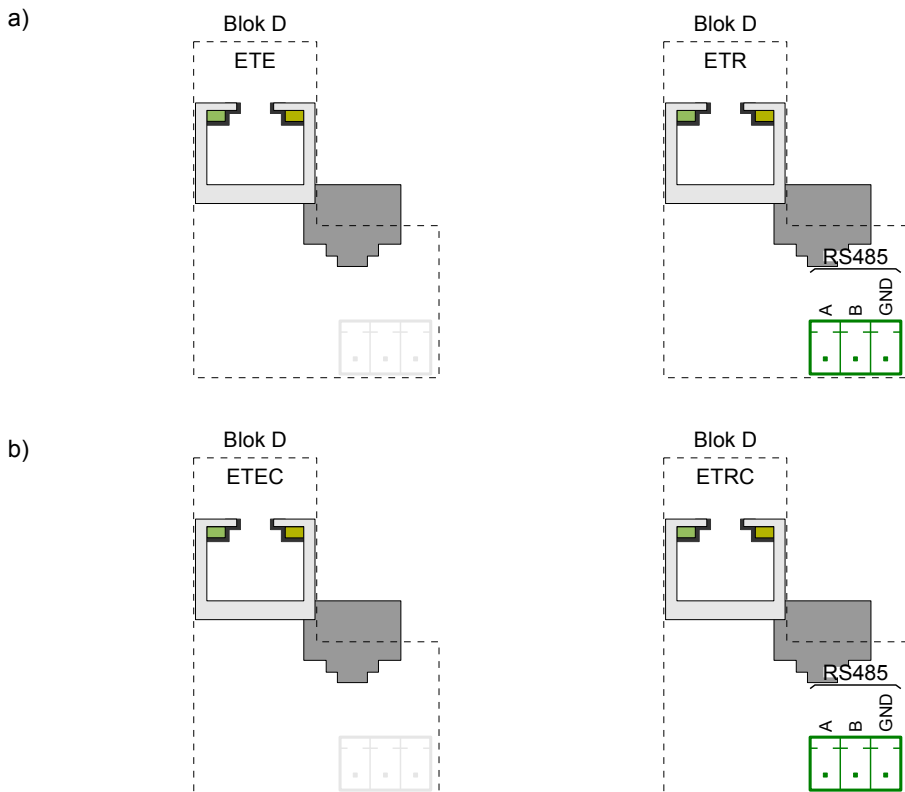
Rys. 8.14. Konfiguracje wejść dla Bloku D a) bez konektora IP67 na obudowie, b) z konektorem IP67 na obudowie
