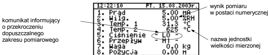
Rys. 6.25. Urządzenie w trybie prezentacji wyników "Lista kanałów". Parametr "Opcje listy kanałów" ustawiony jako "wartości".
