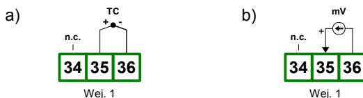
Rys. 4.16. Podłączenia zewnętrzne dla kanału nr 1: a) czujników termoparowych; b) czujników napięciowych
